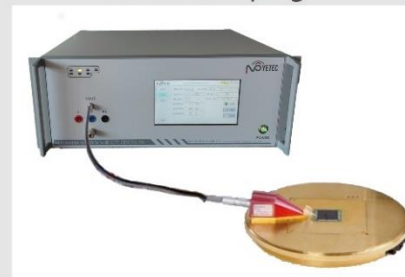
ESD/EFT注入法 ESD/EFT Injection
