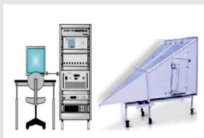
GTEM/TEM小室法 TEM Cell&GTEM Cell
