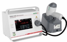
静电放电 (ESD) 抗扰度 Electrostatic Discharge Immunity
