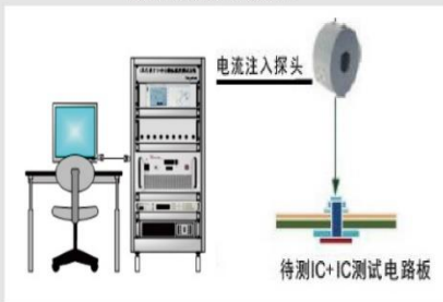
BCI注入法 Bulk Current Injection
